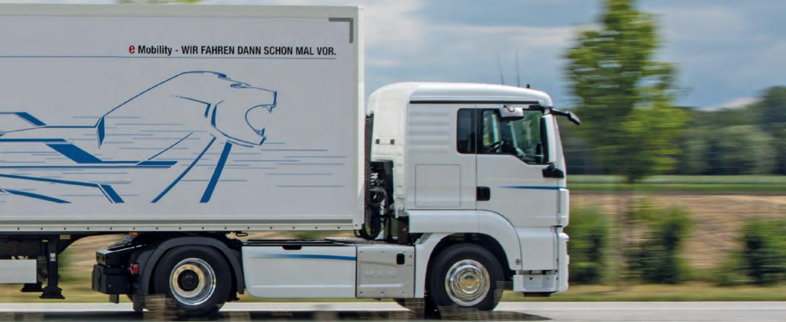
*Elektroantriebe auch für große Lastkraftwagen – MAN eTruck*
