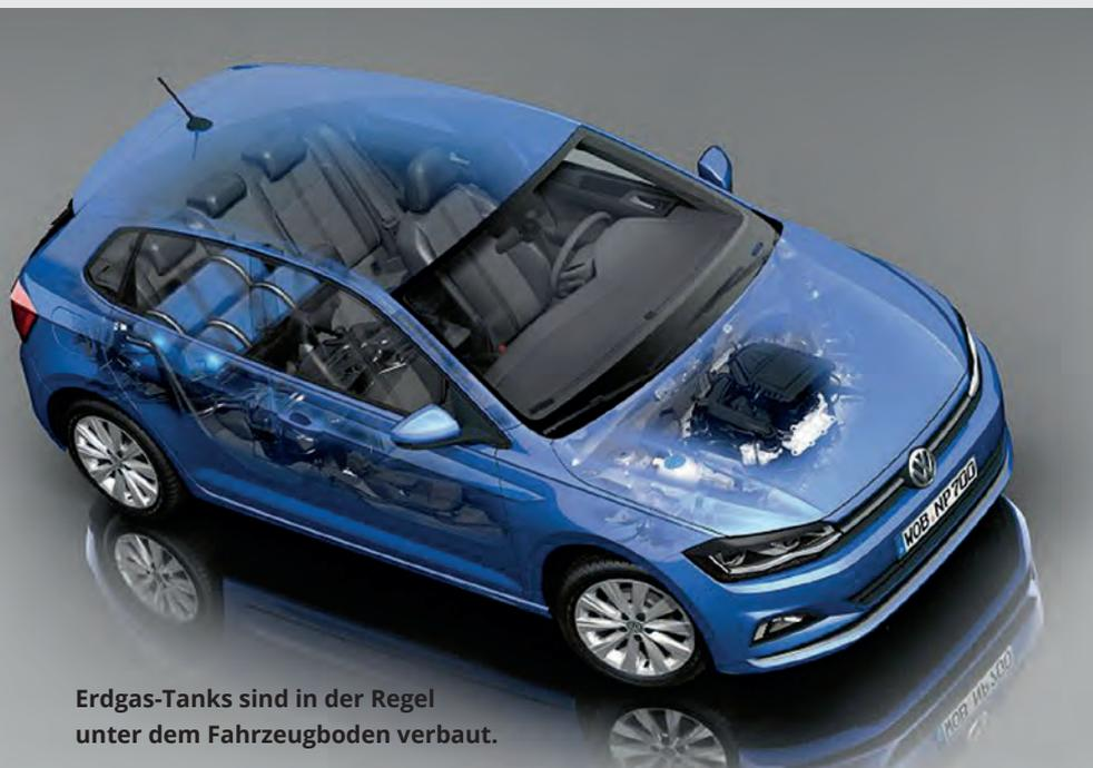
Erdgas-Tanks sind in der Regel unter dem Fahrzeugboden verbaut.
