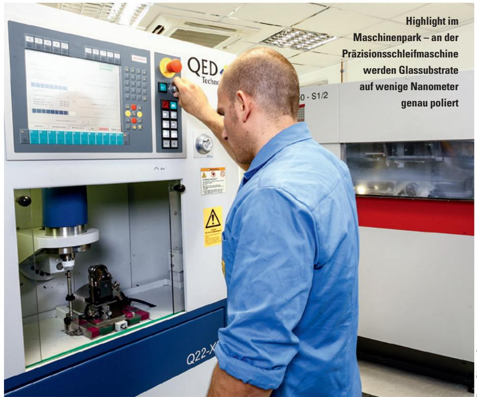
Highlight im Maschinenpark – an der Präzisionsschleifmaschine werden Glassubstrate auf wenige Nanometer genau poliert
