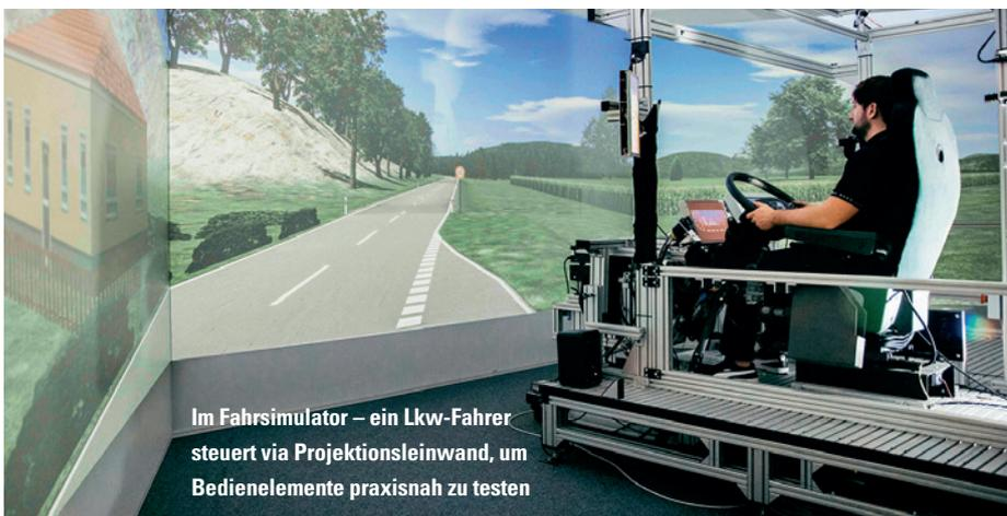
Im Fahrsimulator – ein Lkw-Fahrer steuert via Projektionsleinwand, um Bedienelemente praxisnah zu testen
