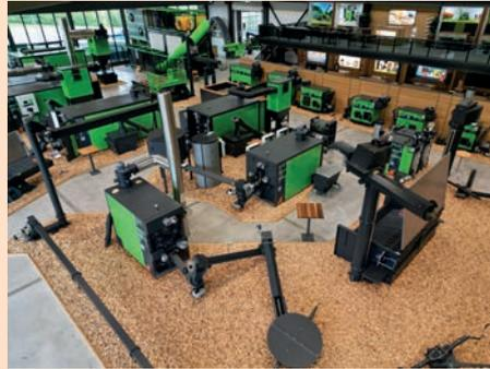
Heizohack. Dahinter stehen professionelle Holzhackmaschinen zur Herstellung von Hackgut aus Stämmen, Gipfelmaterial und Resthölzer. Die handbeschickten Maschinen der Heizohack-Serie haben eine Einzugsöffnung
