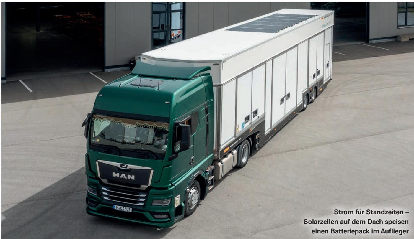
Strom für Standzeiten – Solarzellen auf dem Dach speisen einen Batteriepack im Auflieger
